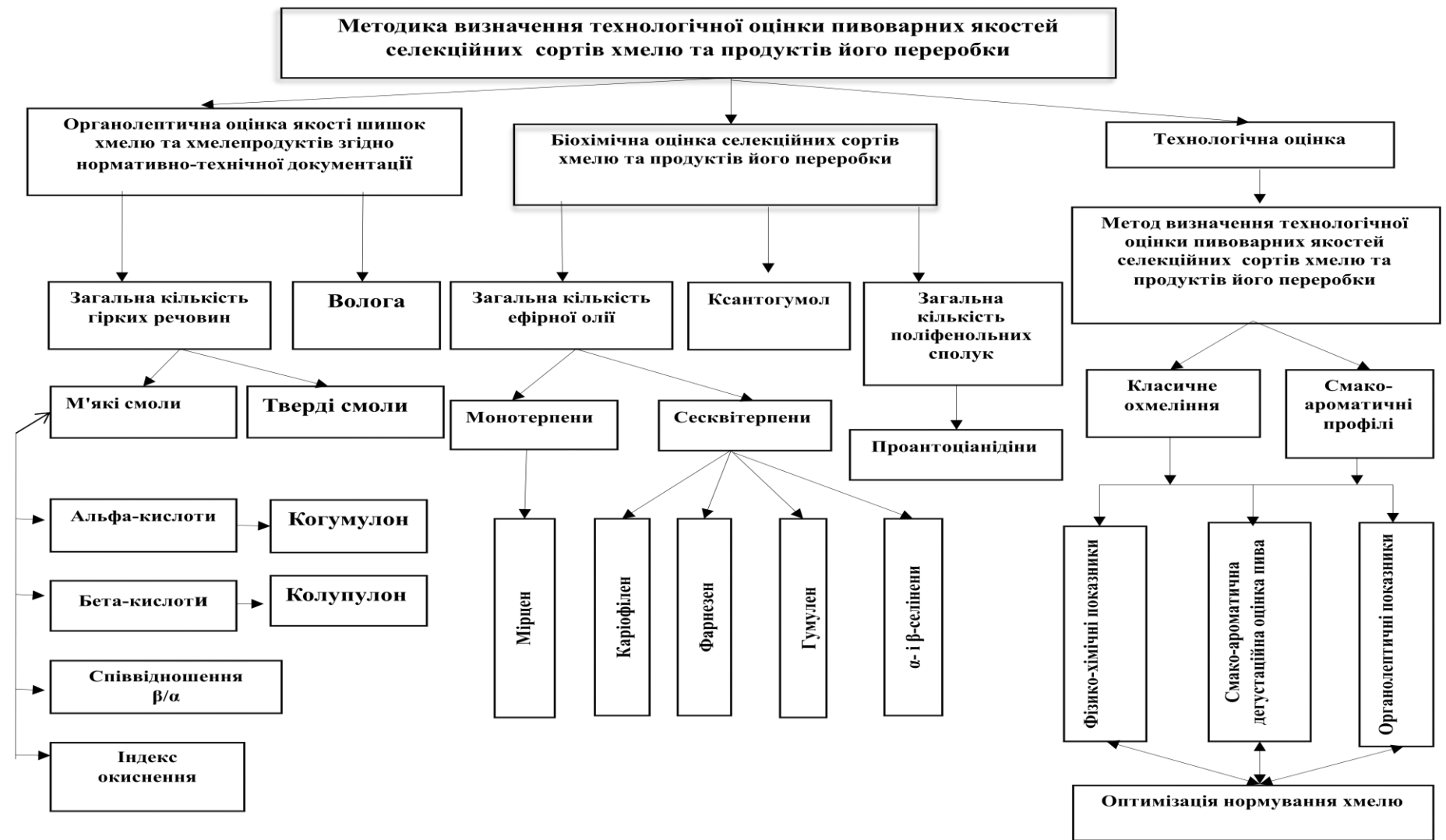
Рис. 12.1 Методика визначення технологічної оцінки пивоварних якостей хмелю селекційних сортів та продуктів його переробки
