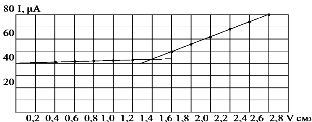
Рис. 6.2 – Графік кондуктометричного титрування екстракту α-кислот розчином оцтовокислого свинцю концентрацією 40 г/дм 3
